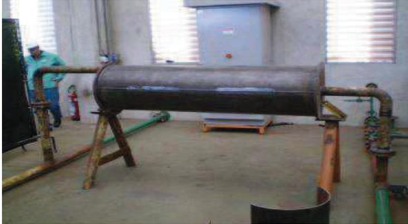
Figura 2.1 – Dispositivo para simulação de soldagem em operação com resfriamento com passagem de água (Cedida por Creduto/Transpetro).
