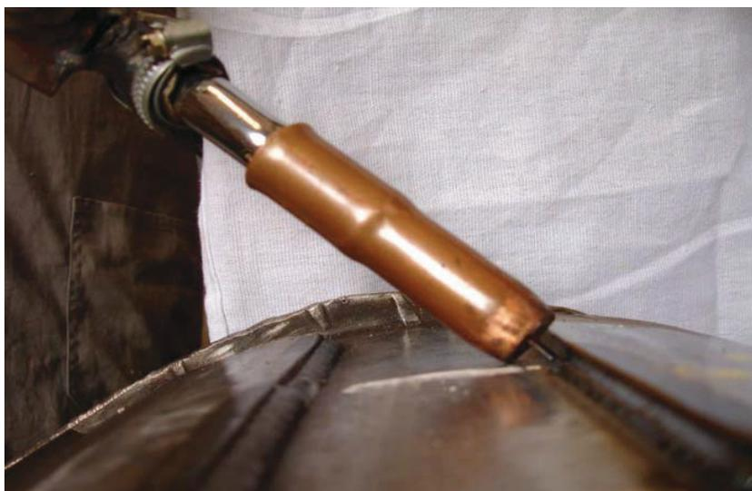
Figura 3.3 – Inclinação da tocha em relação à junta - ângulo de trabalho de 45°.
