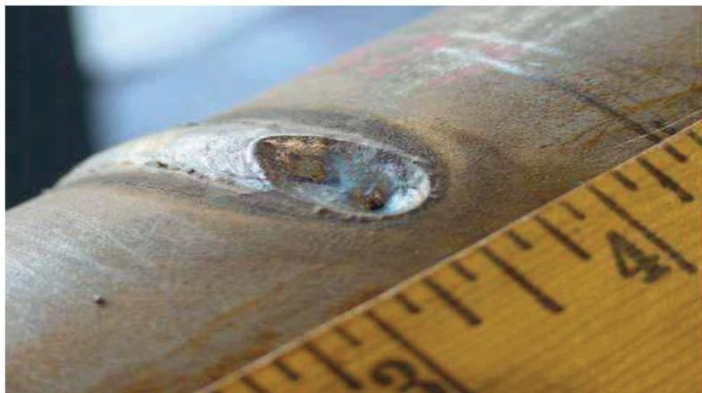
Figura 2.11 – Perfuração provocada por procedimento de soldagem incorreto.
