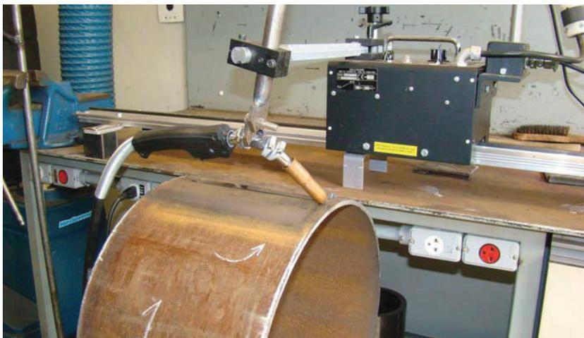
Figura 3.2 – Tartaruga: Dispositivo de fixação e movimentação da tocha.
