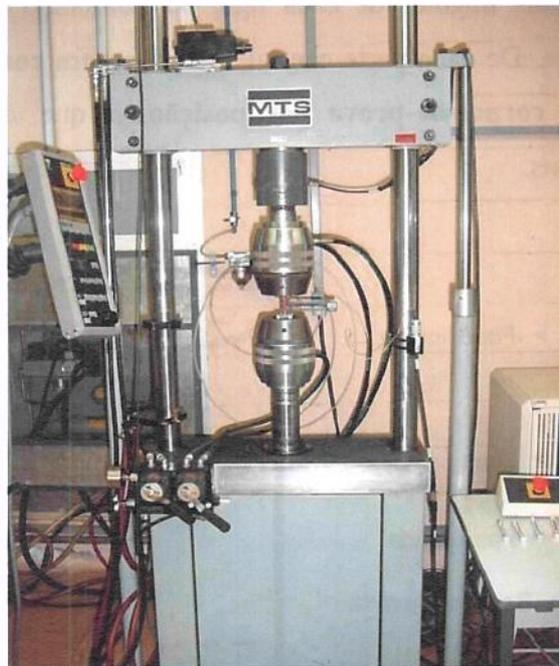
**Figura 4.15** – Máquina de ensaio de tração modelo MTS Test Star II utilizada para os ensaios trativos.
