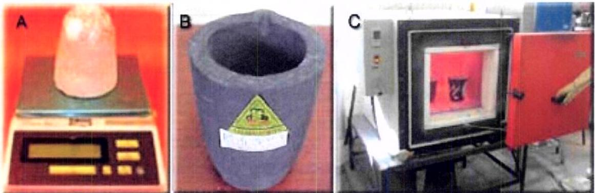
**Figura 4.2 - (A) Balança digital, (B) Cadinho de carboneto de silício e (C) Forno elétrico tipo mufla.**
