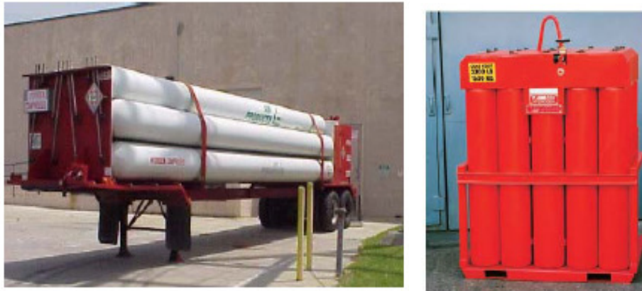
Figura 2.14 – Tubos e cesta de cilindros para transporte gasoso de hidrogênio comprimido. Fonte: HIE team, 2006.
