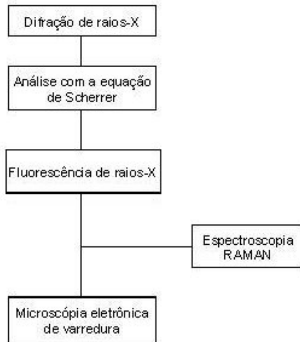
Figura 3.7 – Fluxograma da caracterização dos pós de hidroxiapatita e de titânia.
