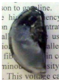
Figura 4.14. Amostra ST049-IT tratada termicamente acima de 1600 °C.
