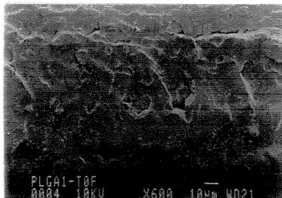
Figura 44- Microscopia eletrônica de varredura de superfície de fratura membrana de PLGA antes da degradação.
