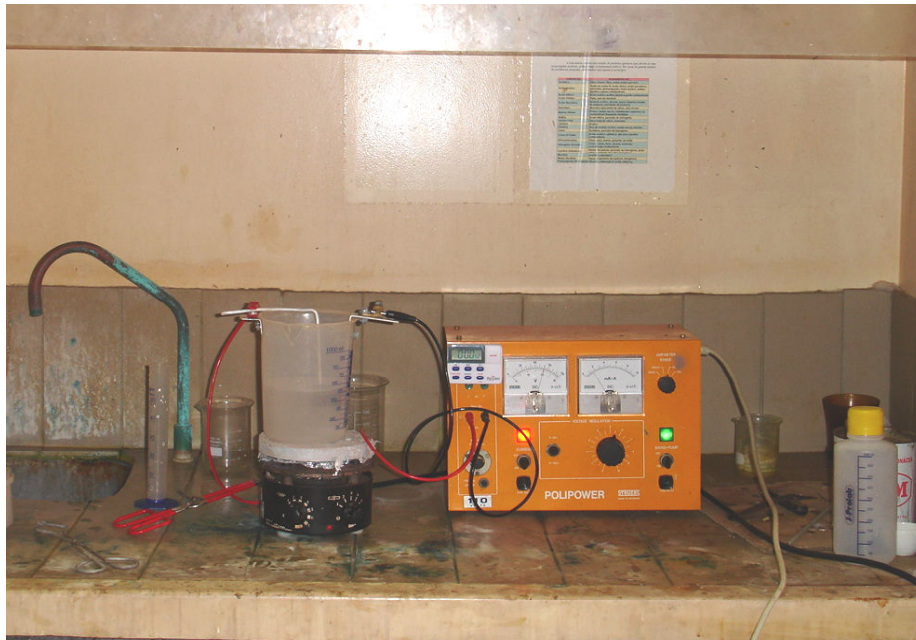
Figura 3.4: Esquema empregado para a realização do ataque eletrolítico com o eletrólito \text{HBF}_4 .
