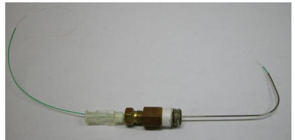
Rosca para adaptar a sonda ao micrômetro.
