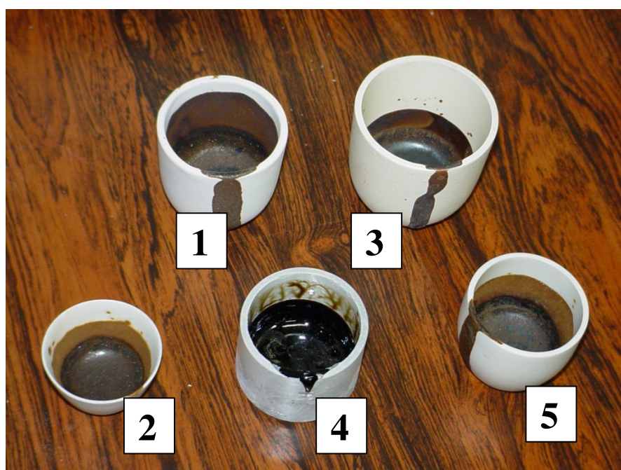
Figura 4.4. Cadinhos testados no início dos experimentos:(1) e (2) cadinhos de alumina de empresa A; (3) cadinho de ZAS (Zircônia-Alumina-Sílica); (4) cadinho de sílica; (5) cadinho de alumina da empresa B.
