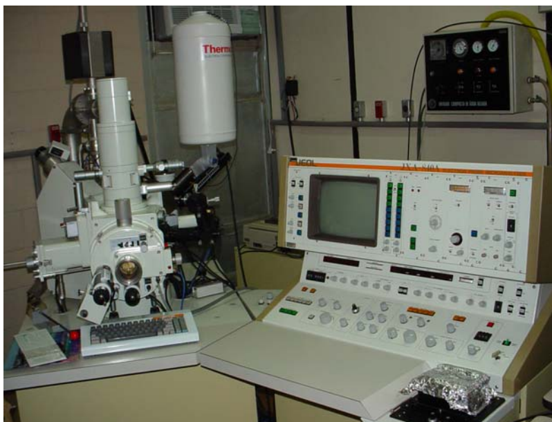
Figura 3.8. Microscópio eletrônico de varredura JEOL, modelo JXA 840-A.
