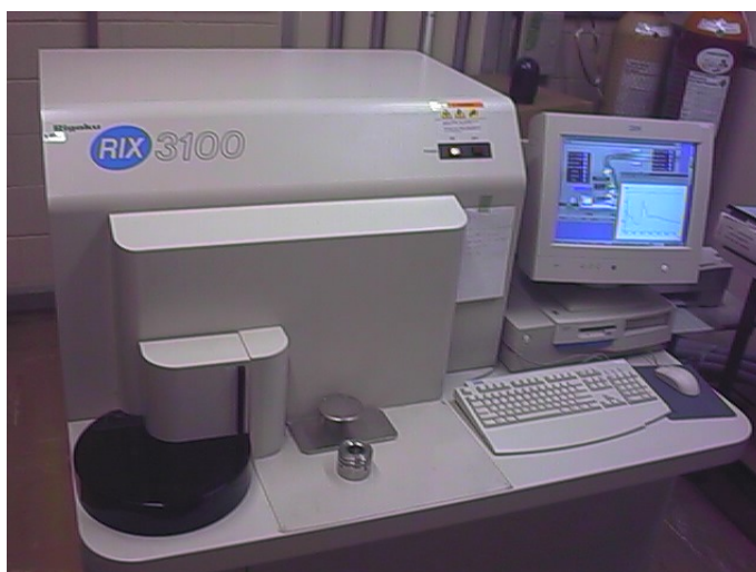
Figura 3.6. Espectrômetro de fluorescência de raios-X, Rigaku, modelo RIX-3100.
