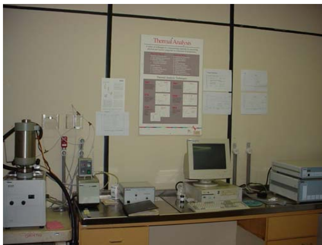
Figura 3.3. Equipamento para o ensaio de DTA - Netzsch-Thermiche Analyse, modelo STA 409-EP.
