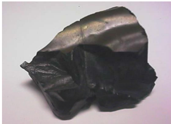
Figura 2.2. Material vitrocerâmico obtido a partir do resíduo hospitalar via plasma térmico.
