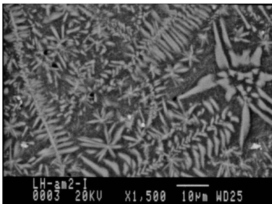
Figura 4.12. Imagem por MEV do material vitrocerâmico de resíduo hospitalar sem resfriamento controlado. Aumento:1500x.
