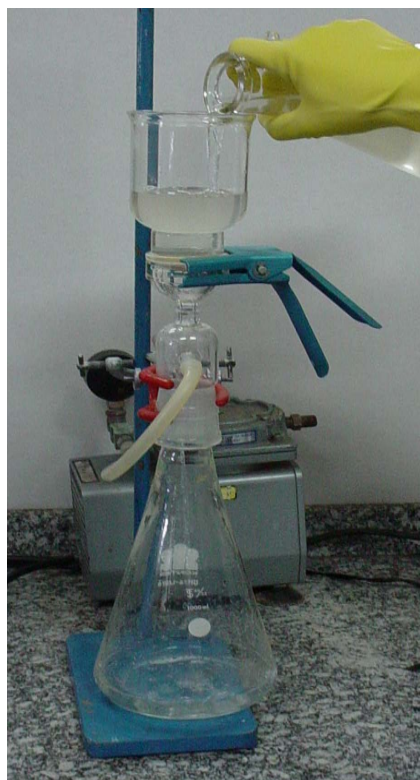
Figura 3.12. Sistema para filtração com membrana de 0,45\ \mu\text{m}
