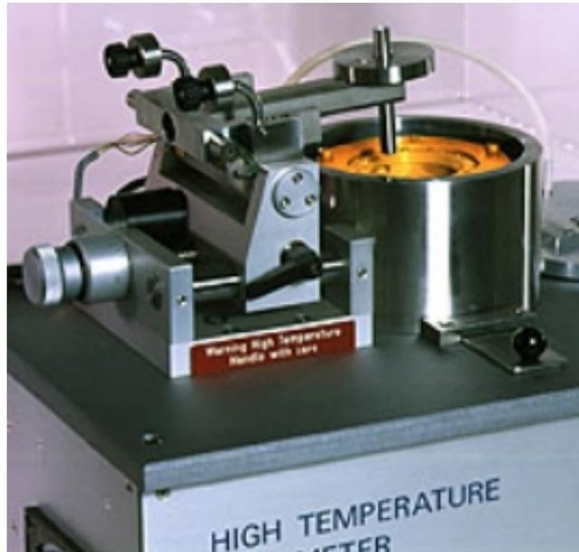
**Figura 6.9** – Máquina de ensaio de desgaste *CSM High-Temperature Tribometer*.
