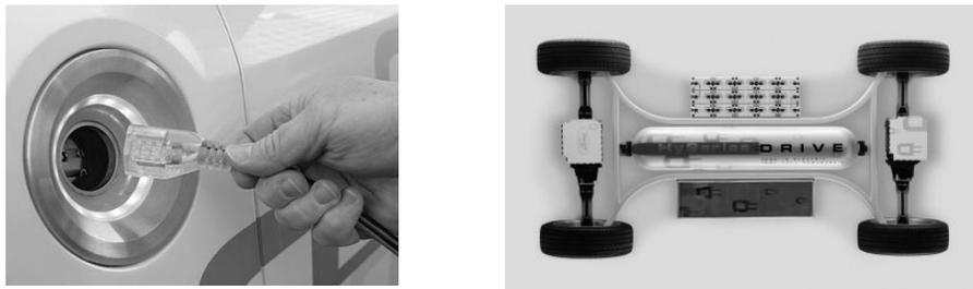
Figura 2.6 – *Plug-in* para recarga da bateria e *HySeries Drive* no Ford *Edge* 2007.
