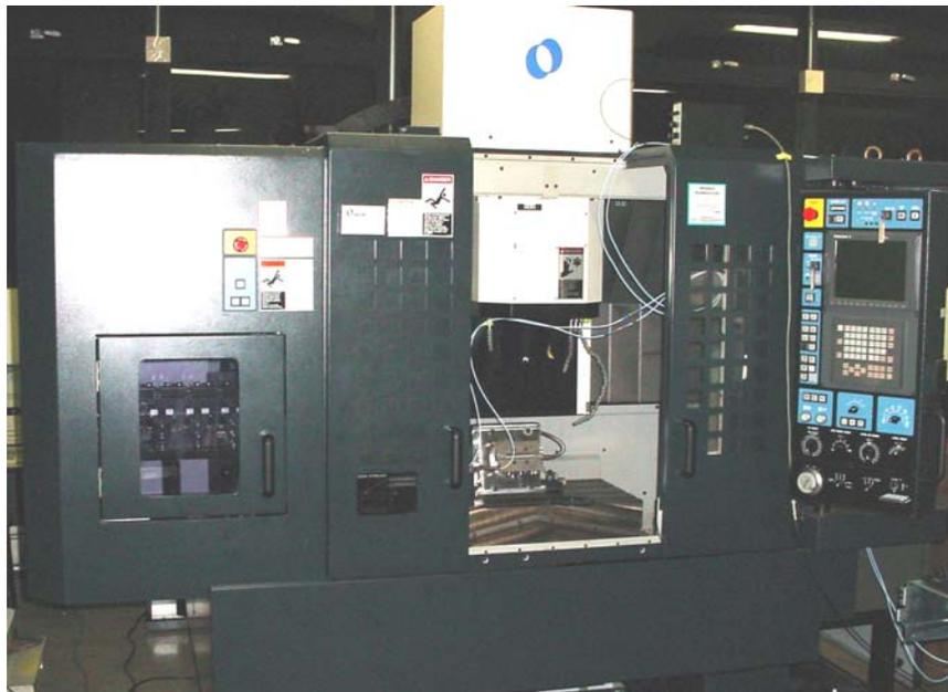
Figura 3.3 Centro de usinagem vertical (Fabricante Makino, modelo V33).
