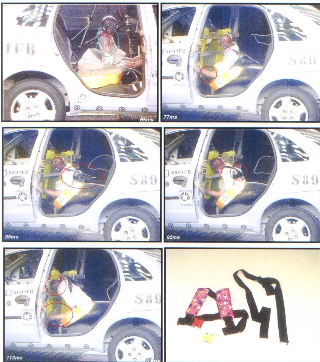
Figuras 38 a 43. Teste II: Ruptura do fecho e do cadarço do cinto de segurança infantil, acarretando na grande movimentação do ‘dummy’ para a frente durante o teste, com forte impacto das pernas/pés e cabeça/rosto contra a região traseira do encosto do banco dianteiro
