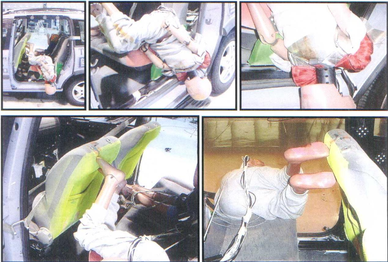
Figuras 66 a 70. Teste IV: Posição final do 'dummy' após o teste
