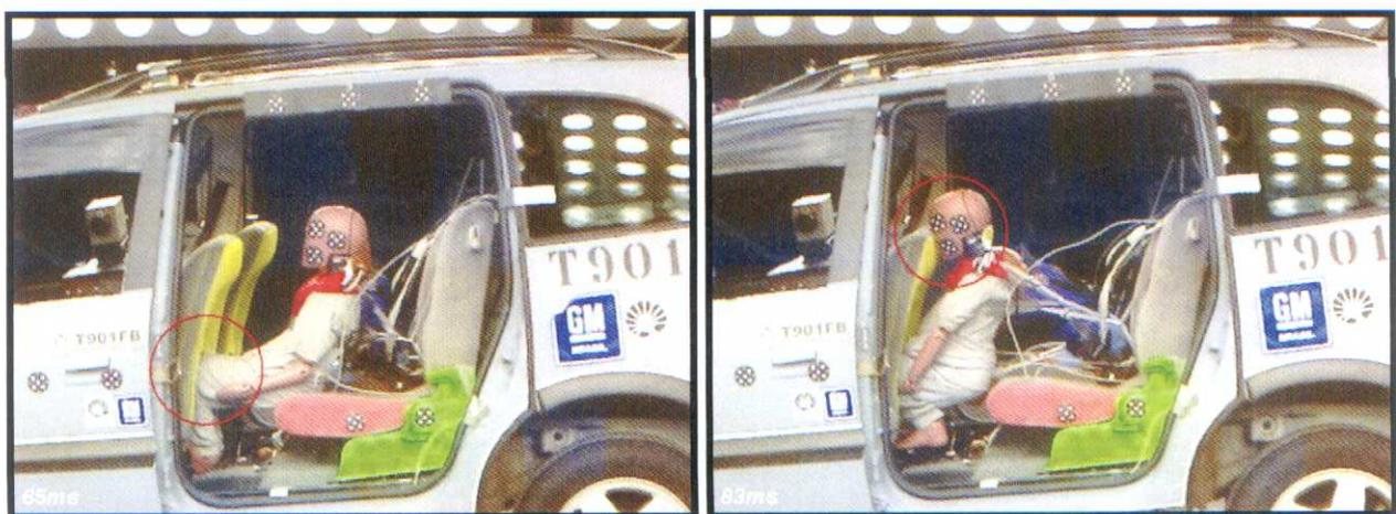
Figuras 62 e 63. Teste IV: Impacto dos joelhos e cabeça do ‘dummy’ na parte traseira do encosto do banco dianteiro lado esquerdo
