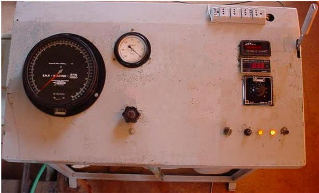
Figura 16 – Painel de instrumentos e de controle. Na fotografia é possível observar os seguintes componentes posicionados da esquerda para a direita e de cima para baixo: manômetro indicador de torque, manômetro de pressão de admissão, válvula de controle de carga do dinamômetro, conta-giros, termômetro, chave seletora de termopar, chave de partida, fusível, lâmpadas spia do alternador e de pressão de óleo, botão de emergência e manopla do acelerador.
