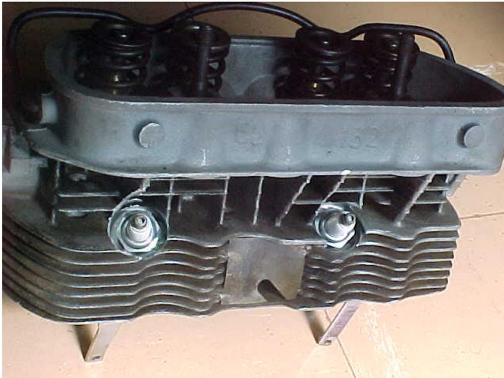
Figura II-2 – Vista da parte inferior do cabeçote, evidenciando o posicionamento das velas extras.
