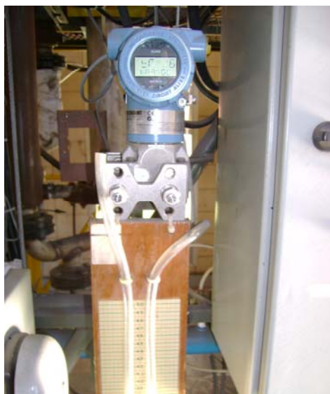
Figura 3-15 Transdutor de pressão conectado em paralelo ao manômetro de coluna d'água.
