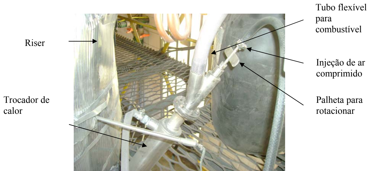
Figura 3-10 Ejetor de sólidos para alimentação do combustível.
