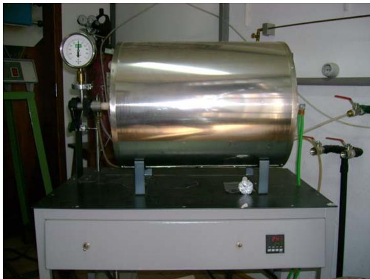
Figura 3.6. Visão lateral do forno de tratamento térmico utilizado nos tratamentos térmicos de envelhecimento.
