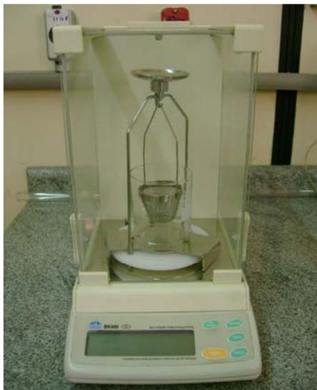
Figura 3.1. Balança de precisão com sistema para definição da densidade do material.
