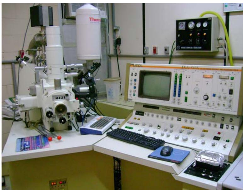
Figura 3.5. Microscópio eletrônico de varredura.
