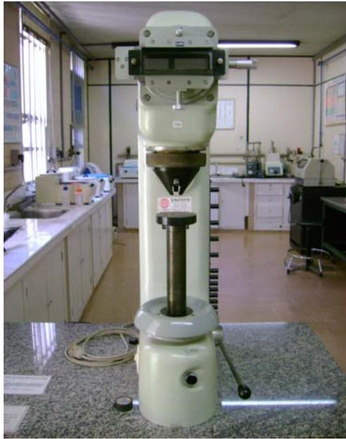
Figura 3.7. Medidor de dureza Vickers.
