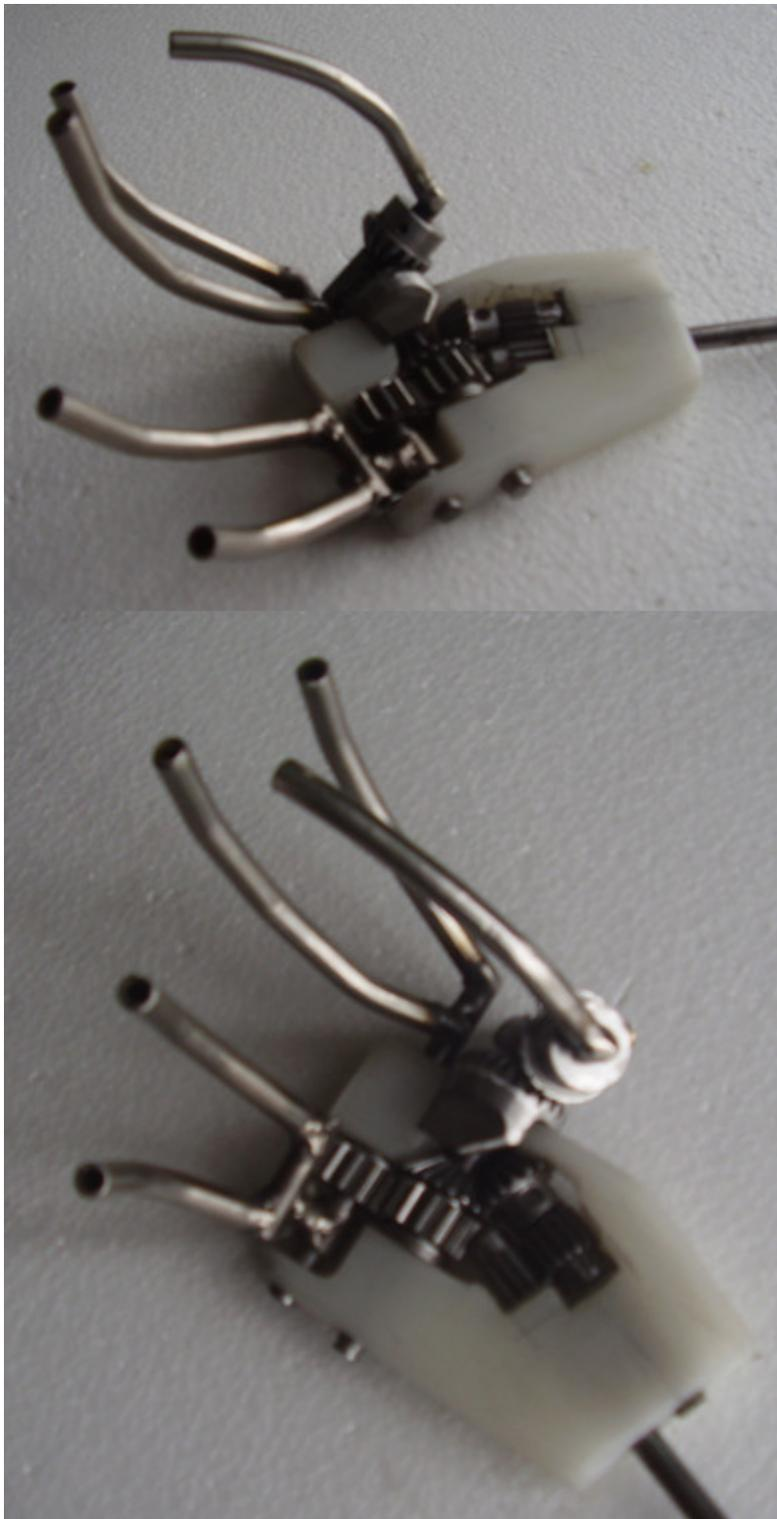
Figura A.37 – Detalhes da mão usinada (protótipo 3)
