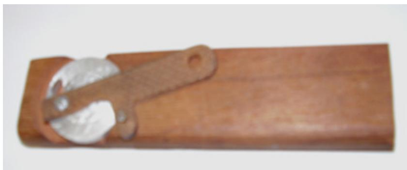
Figura A.31 – Modelo com rasgo excêntrico
