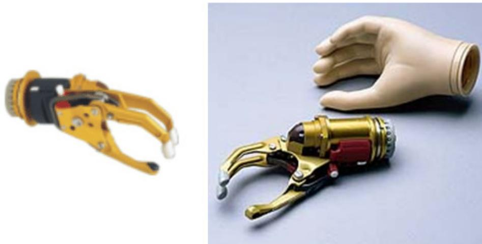
Figura 2.3 – Mão mioelétrica Sensor [OTTOBOCKUS, 2007]
