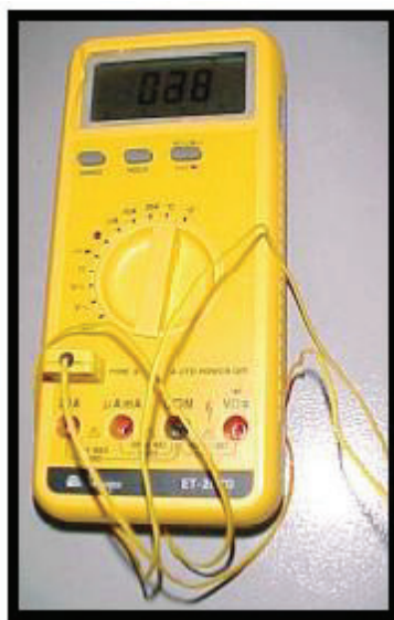
Figura 3.25 – Multímetro Minipa, Modelo ET-2070 , com termopar tipo K calibrado
