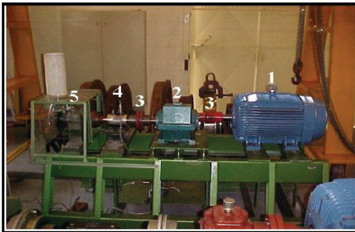
Figura 3.10 – Dispositivo de Ensaio de Amostras (DEA)
