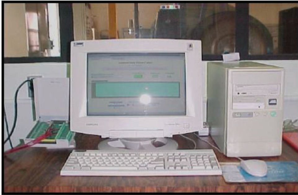
Figura 3.7 – Computador com Placa de Aquisição de Dados NI 6024E e Módulo Externo para Conexão de Sinais SCB-68 a esquerda.
