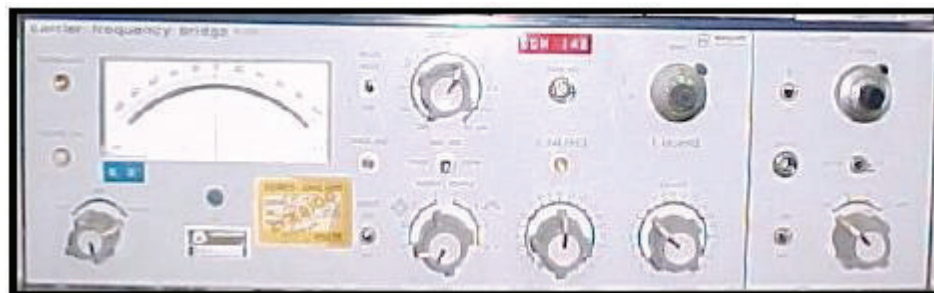
Figura 3.9 – Ponte Condicionadora de Sinais Phillips modelo PR9308.
