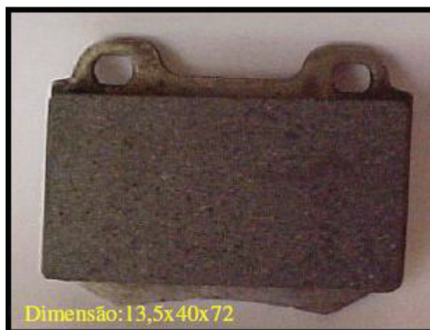
Figura 3.30 – Amostra de Material de Atrito (Pastilha) retirada da Sapata Ferroviária
