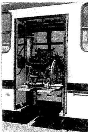
Figura 2.6 Elevador eletro- hidráulico para cadeiras de rodas em ônibus urbano.
