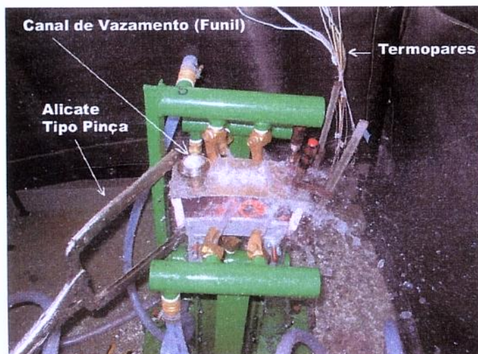
Figura 4.8: Ensaio experimental durante o vazamento, alicate de pressão tipo pinça no aperto da tampa.
