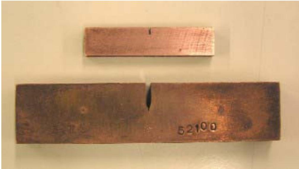
Figura 3.5 – Fotografia dos corpos de prova de CTOD com  $W = 20$  mm com incisão feita por eletroerosão, e  $W = 10$  mm com entalhe chevron esquematizado na figura 3.8, feito por eletroerosão.
