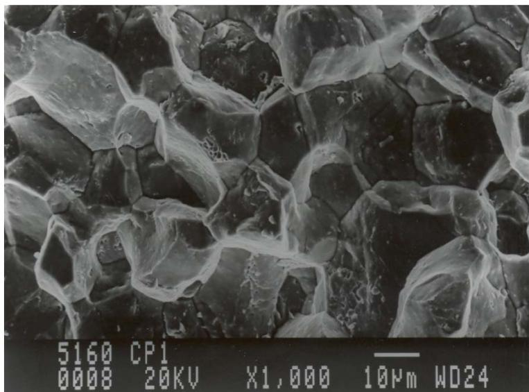
Figura 4.24.F – Fractografia dos corpos de prova de tenacidade à fratura para o aço SAE 5160. Idem a acima, com maior aumento, onde se detalha a predominância de fratura intergranular.
