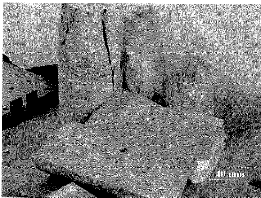
Figura 5.10 Vista geral do plano de ruptura de corpos de prova de concretos rompidos na compressão e na compressão diametral (tração indireta).
