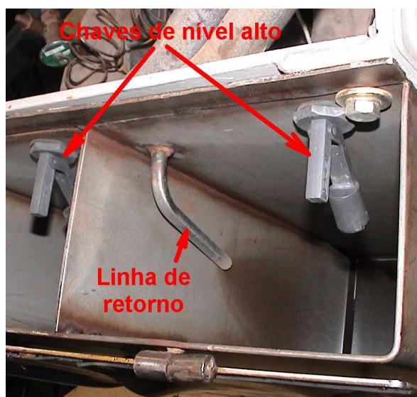
Figura 6.11 – Interior dos reservatórios
