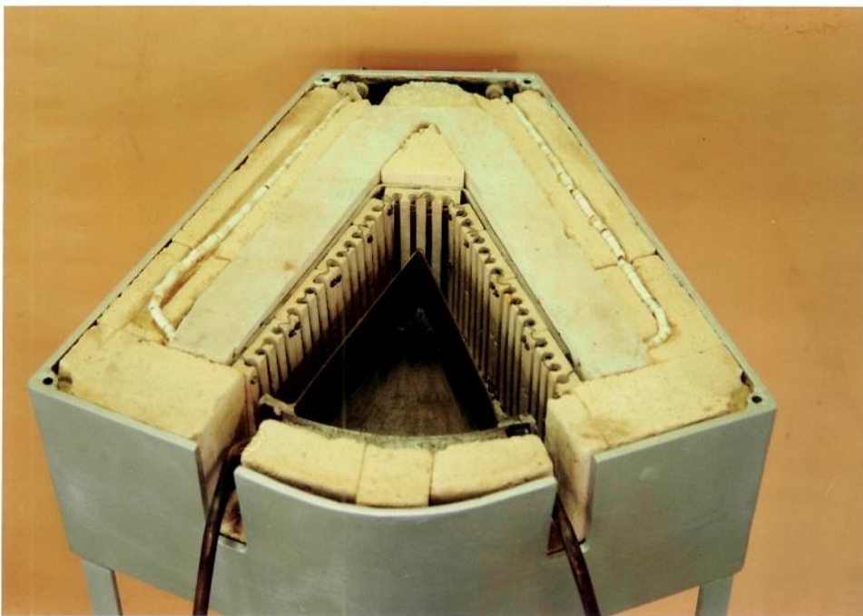
Fig. (4.3) - Foto do dispositivo utilizado para simulação de solidificação radial
