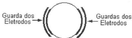
Figura 4.5 - Guardas dos eletrodos com potencial igual aos eletrodos adjacentes.
