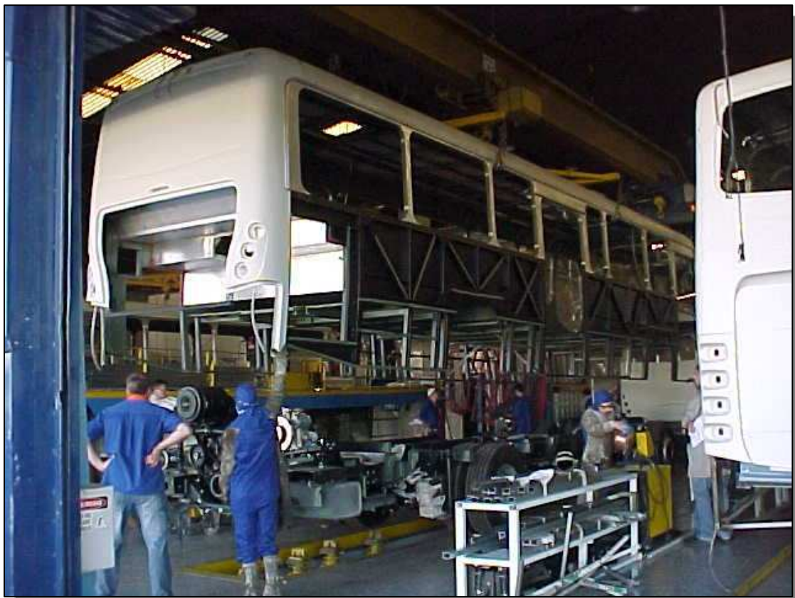
Figura 2.1.3 : Ônibus completo: chassi + carroceria (Fonte: Marcopolo)
