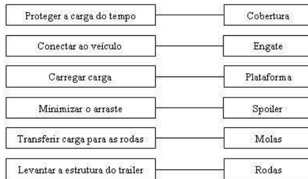
Figura 3.2.3 : Uma arquitetura modular exibindo um mapeamento um a um entre funções e seus componentes. (Ulrich, 1995)
