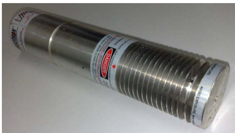
Figura 3.8. Laser Morgotron de criptônio com 35mW.
