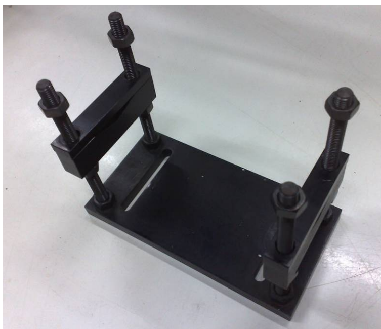
Figura 3.7. Suporte de alumínio para o laser e o conjunto expensor.
