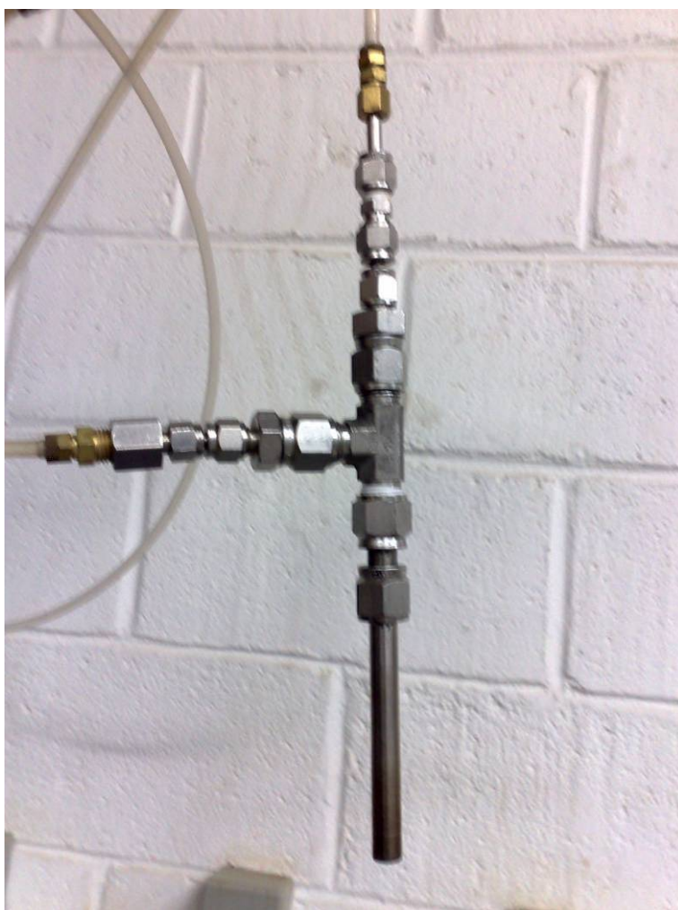
Figura 3.17. Bico injetor conectados às mangueiras plásticas.
