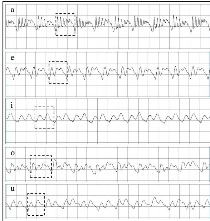
Fig. 6.3 – Comparação entre fonemas ‘a’, ‘e’, ‘i’, ‘o’, ‘u’, respectivamente de cima para baixo.
