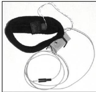
Fig. 3.2 - Sensor piezoelétrico e amplificador (fonte: Felzer e Nordmann, 2007).
