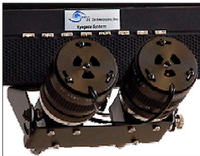
Fig. 2.6 - *Eyegaze*, capaz de ler o posicionamento do olho (fonte: LC Technologies, 2007).
