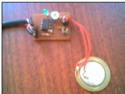
Fig. V.1 – Amplificador Piezoelétrico
