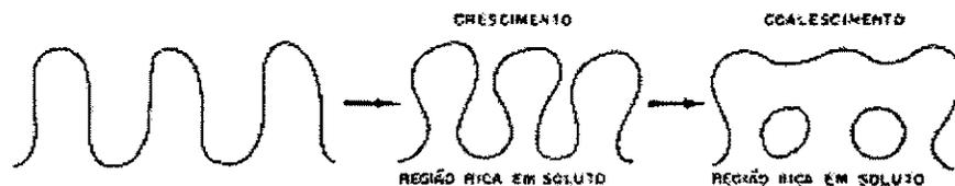
**Figura 2.18** - Esquema ilustrativo da formação das regiões ricas em soluto no fenômeno do coalescimento dos ramos dendríticos secundários [ Chien/Kattamis,1970;Flemings,1974].
