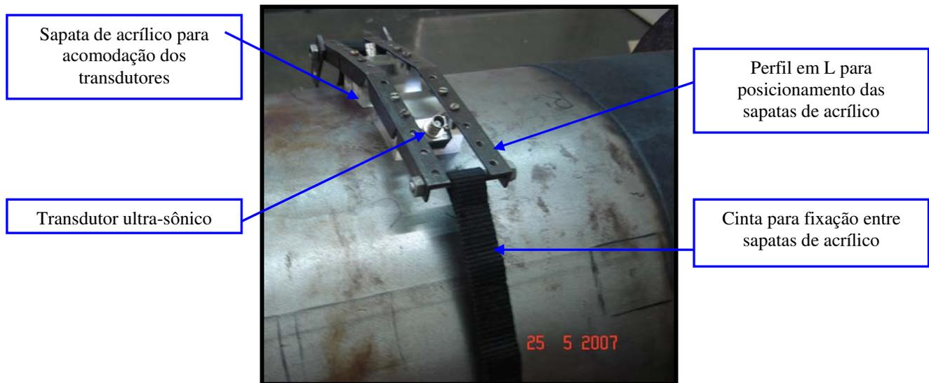
Figura 3.55: Sapatas de acrílico unidas por perfis em L posicionadas sobre duto através de uma cinta.
