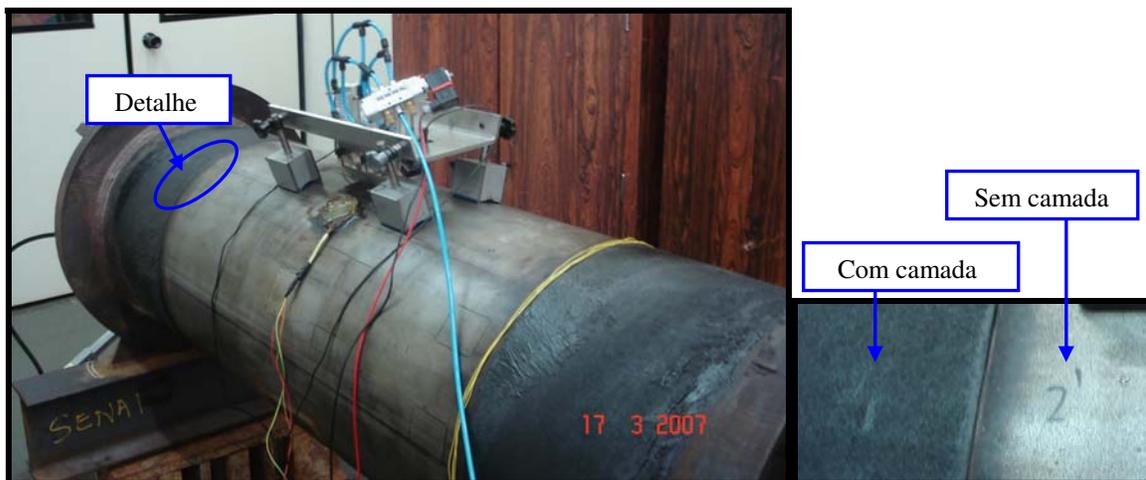
Figura 3.1: Duto construído com aço API 5L X65. Detalhe: Com e sem camada protetora.
