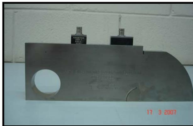
Figura 3.47: Transdutores localizados sobre bloco padrão para calibração.
