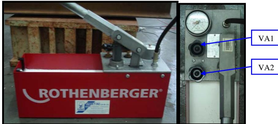
Figura 3.21: Bomba para teste hidrostático. Detalhe: Válvulas de segurança e manômetro.
