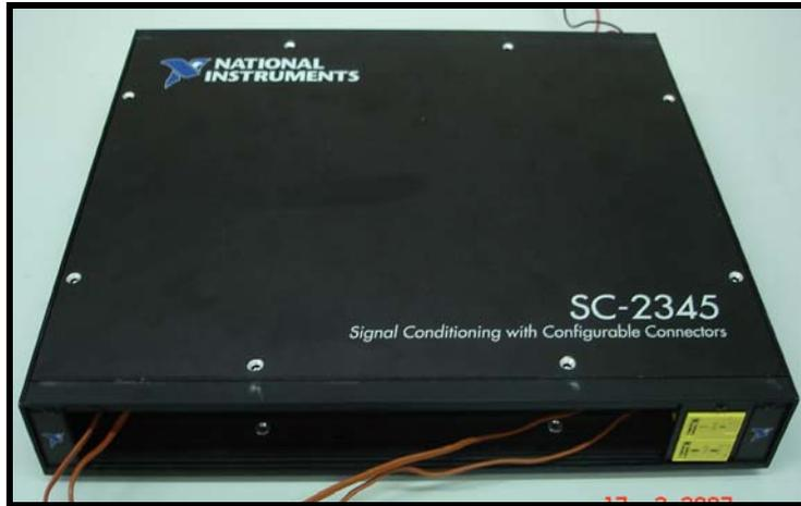
Figura 3.38: Condicionador de sinais *NI SC-2345*.
