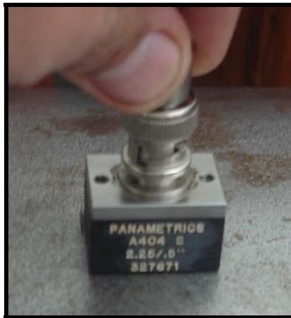
Figura 3.49: Transdutor ultra-sônico de 2,25 MHz colocado sobre duto para medição de espessura.
