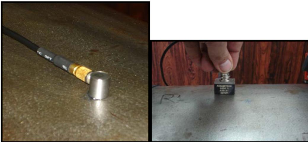
Figura 3.50: Transdutores ultra-sônicos de 5 MHz colocados sobre duto para medição do módulo de elasticidade.
