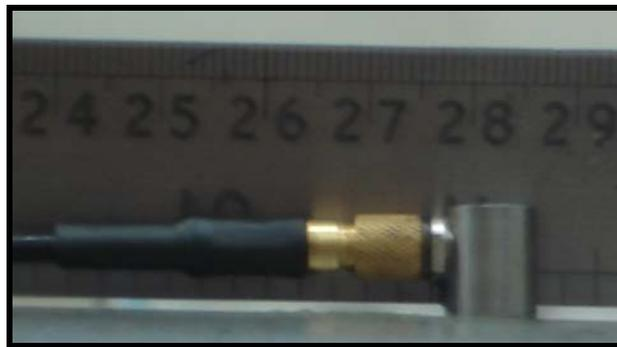
Figura 3.10: Transdutor ultra-sônico para geração de ondas transversais – 5 MHz –  $\varnothing$  0,25''
