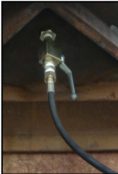
Figura 3.51: Conjunto válvula de esfera, engate rápido e mangueira de alta pressão para utilização em duto para teste hidrostático.
