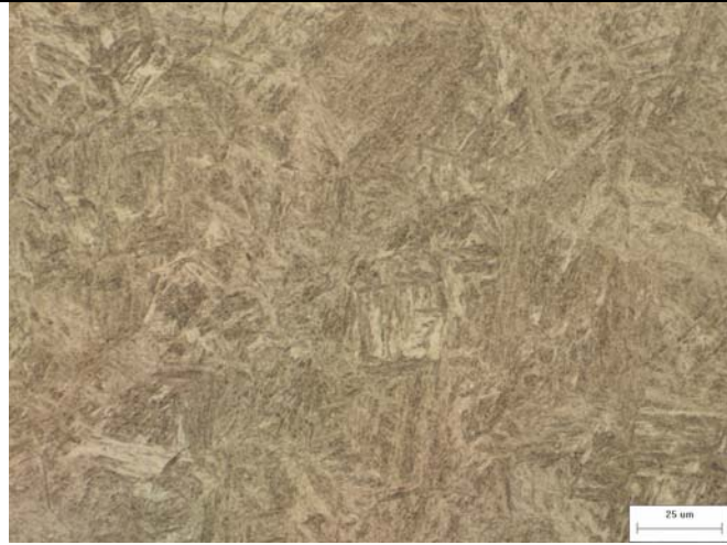
4330 Revenido a 200 °C – Ataque com Nital 5%
