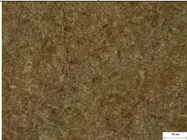
4390 Revenido a 600 °C – Ataque com Nital 5%
