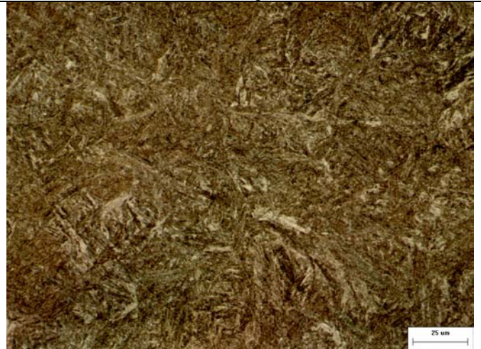
43100 Revenido a 500 °C – Ataque com Nital 5%
