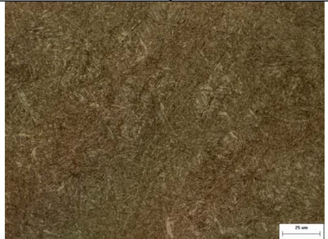
4350 Revenido a 500 °C – Ataque com Nital 5%
