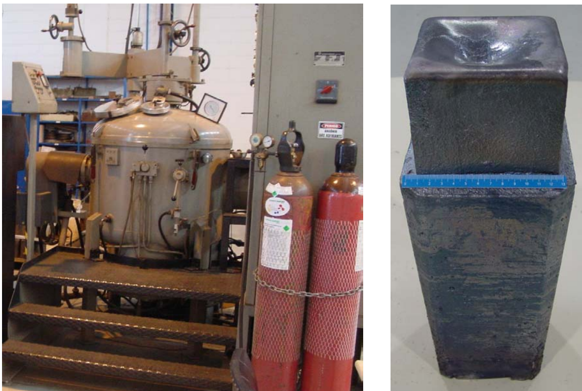
Figura 3.1 – Fotografias Forno de Indução a Vácuo (V.I.M.) utilizado na fusão dos lingotes, e um lingote de 50 kg com seção transversal quadrada de 140 mm e comprimento de 500 mm (gentileza Villares Metals SA).
