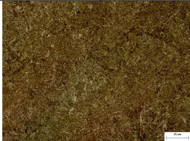
4350 Revenido a 400 °C – Ataque com Nital 5%
