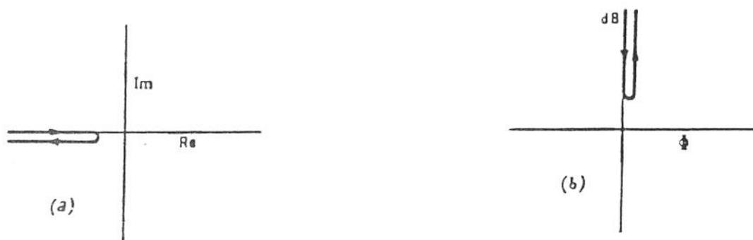
Fig. 2.13 - lugar crítico  $c(x_1) = -1/B(x_1)$  de um elemento de máximo e mínimo com zona morta  $\Delta$  Coordenadas (a) de Nyquist (b) de Black
