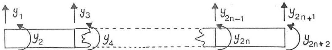
fig.5 - Sistema de coordenadas para modelo de elementos finitos da viga
