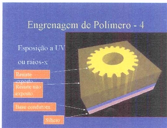
Figura 3.3: Obtenção de uma máscara com o desenho ou padrão desejado.
