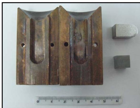
Figura 3.5. Molde de cobre para obtenção de amostras na forma de paralelepípedo.
