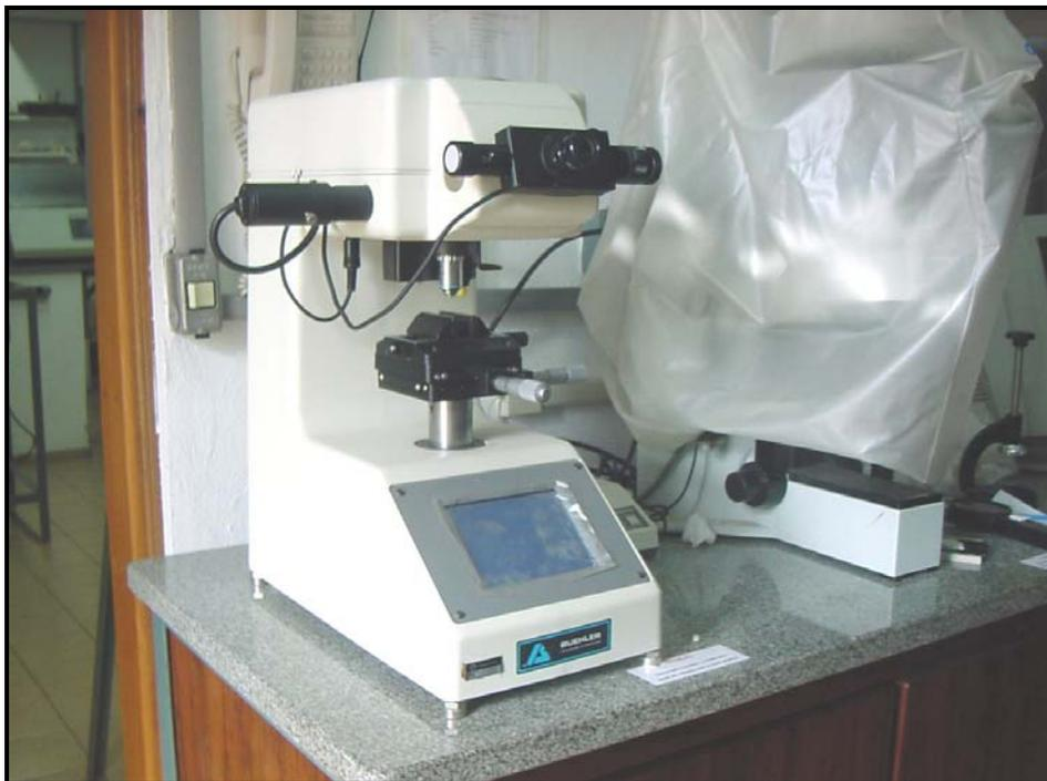
Figura 3.9. Equipamento empregado nas medidas de dureza.
