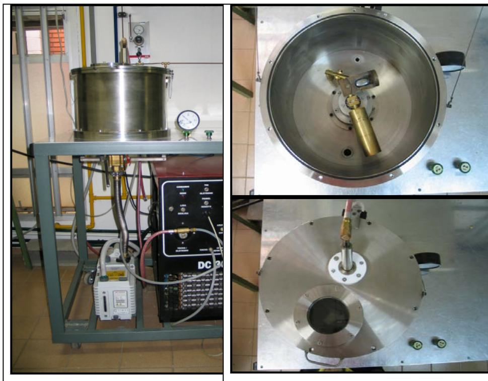
Figura 3.4. Vistas do equipamento de fundição por centrifugação.
