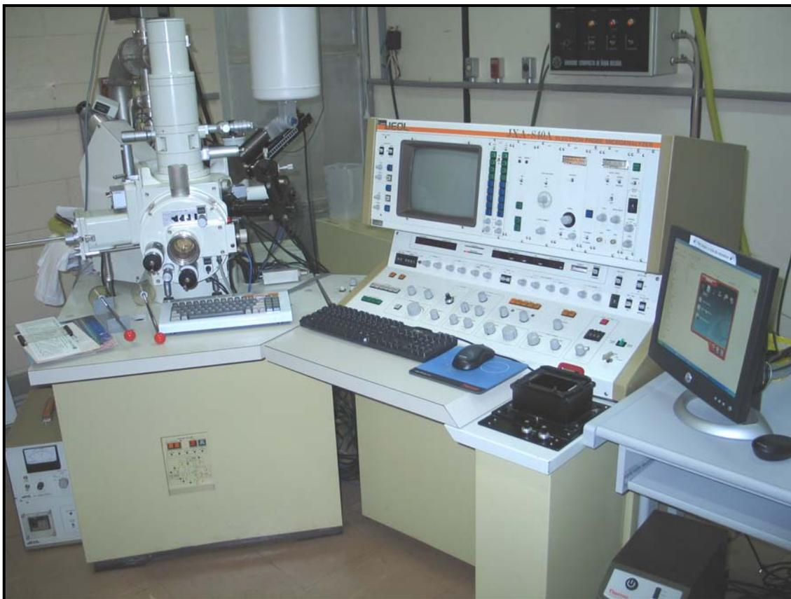
Figura 3.7. Microscópio eletrônico de varredura (MEV).
