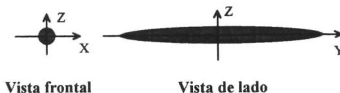
Fig.3.36 - Vista frontal e de lado do volume de medida que possuía a forma de um elipsóide de revolução. O comprimento era cerca de 12,5 vezes maior do que o diâmetro.
