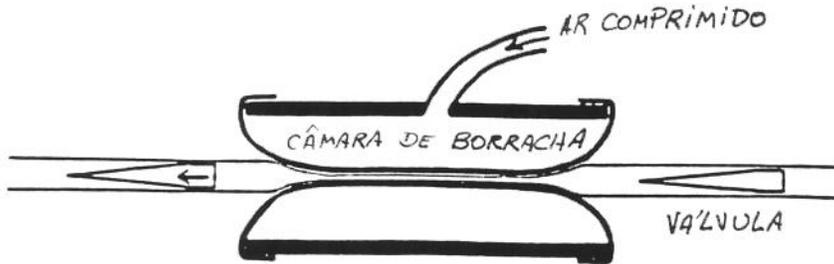
Fig. 1.6 - Detalhe da bomba de efeito pneumático utilizada por Björk para perfusão cerebral de sangue oxigenado em cães. Adaptado de BJÖRK (1948).
