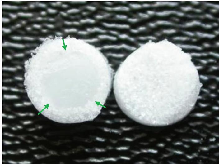
Figura 5.19: Imagem de uma amostra cortada horizontalmente, as flechas mostram o núcleo do interior da área porosa.
