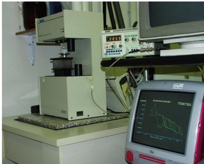
Figura 4.6. Foto do equipamento tensiômetro Wilhelmy.
