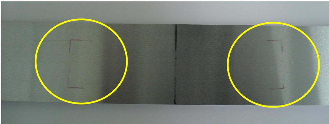
Figura 4.11 – Marcas na peça para posicionar a probe.
