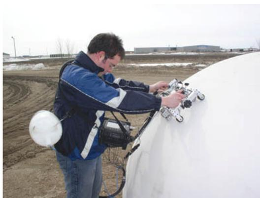
Figura 1.1 – Sistemas automatizados e portáteis de inspeção por ultra-som (site: [www.olympusndt.com](http://www.olympusndt.com))
