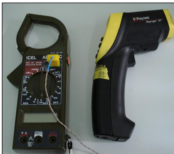
Figura 4.10 – Foto do multímetro com termopar e do pirômetro digital.
