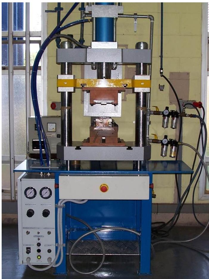
Figura 3.8: Conjunto de equipamentos utilizados na realização dos ensaios de tixoforjamento (segundo conjunto - prensa pneumática).
