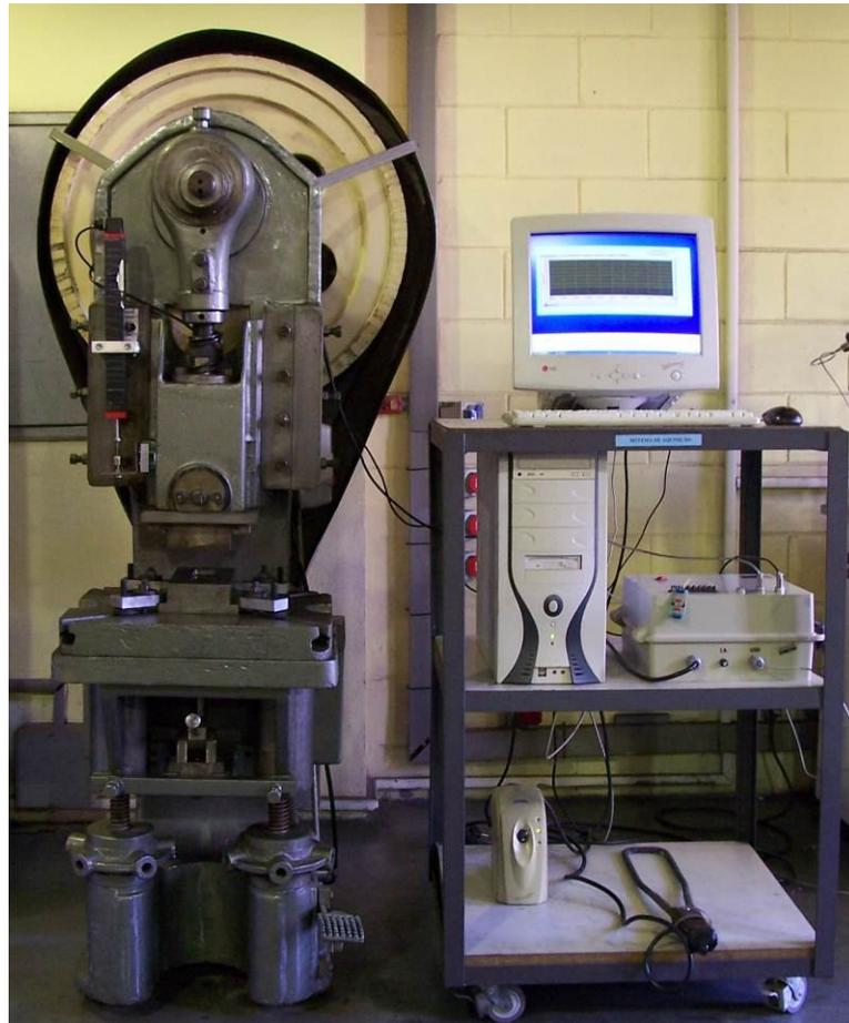
Figura 3.7: Conjunto de equipamentos utilizados na realização dos ensaios de tixoforjamento (primeiro conjunto - prensa excêntrica).
