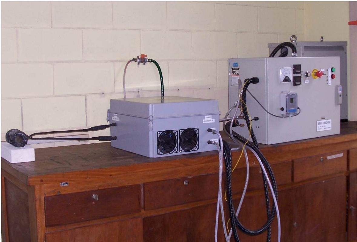
Figura 3.4: Forno indutivo utilizado nos tratamentos térmicos de globularização.
