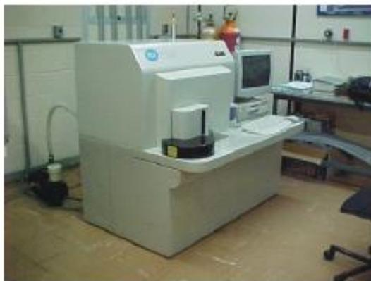
**Figura 3.8** - Espectrômetro de fluorescência de raios X, modelo Rigaku RIX 3100.
