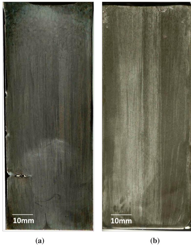
**Figura 4.6.** Macroestruturas das ligas: a) Zn-1,0%Cu e b) Zn-2,2%Cu.
