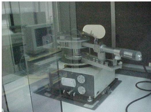
Figura 3.3 – Difratômetro utilizado para ensaio de difração de raios X nas ligas estudadas.
