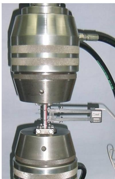
**Figura 3.6:** Visualização do corpo-de-prova durante a execução do ensaio de tração, com o extensômetro para medida da deformação acoplado à parte útil.
