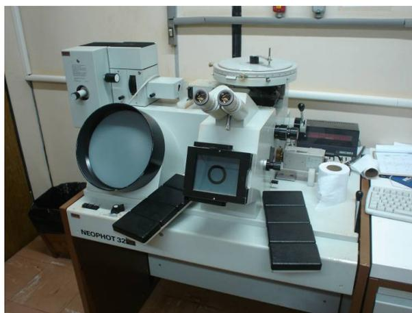
Figura 3.2 – Microscópio ótico utilizado para observação das ligas estudadas.
