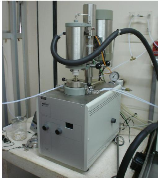
Figura 3.4 – Equipamento utilizado no ensaio de análise térmica das ligas estudadas.
