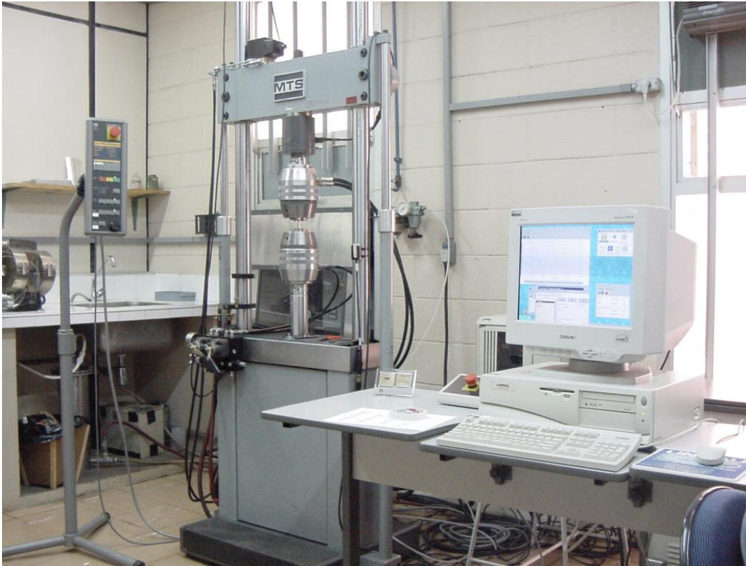
Figura 3.1 - Máquina MTS utilizada para execução do ensaio de tração.
