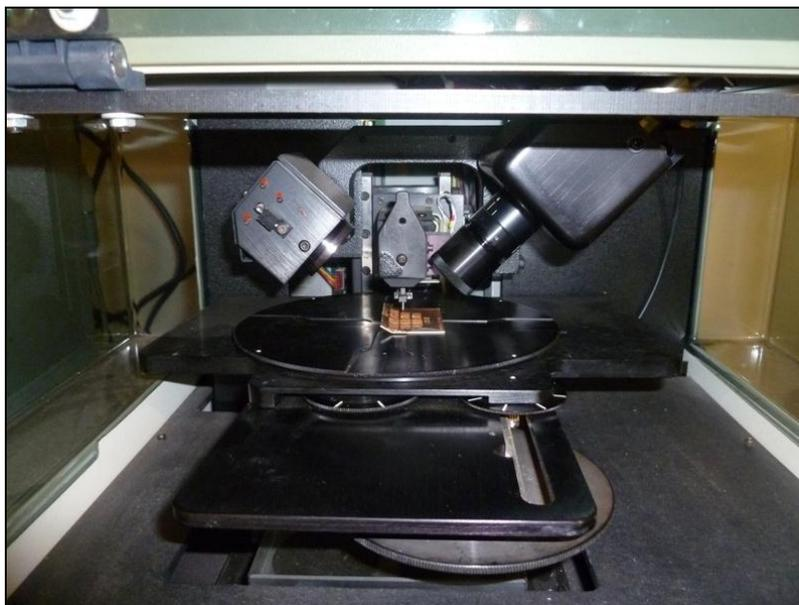
Figura 2.3 – Local onde são inseridas as amostras no perfilômetro do LMF.
