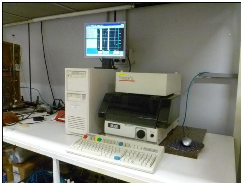
Figura 2.2 – Perfilômetro Veeco Dektak 3ST do LMF utilizado nos experimentos.
