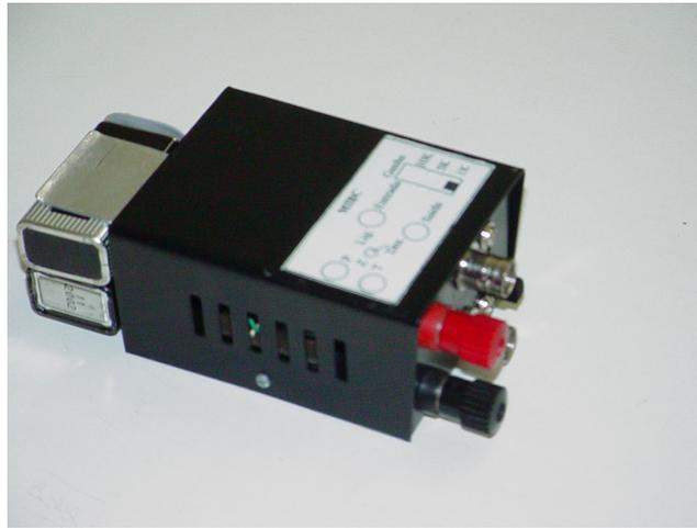
Fig. 4.2: Dispositivo de baixo custo para condicionamento dos sinais  $V_{in}$  e  $V_{out}$  [31].
