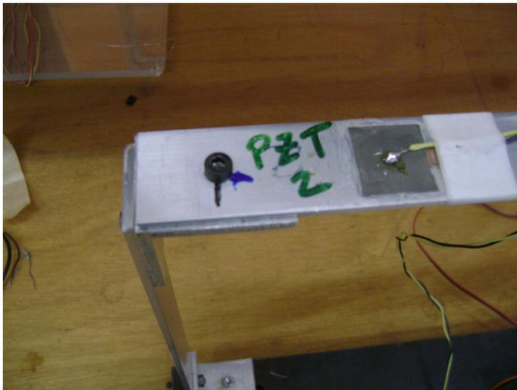
(b) Detalhe da junção parafusada e de um PZT colado no *frame*. As marcas nos parafusos servem como referência no momento de apertos e desapertos.
