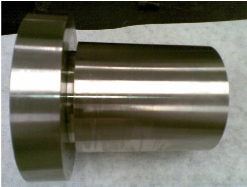
Figura 3.3 - Foto do corpo de prova utilizado nos ensaios de vida de ferramenta
