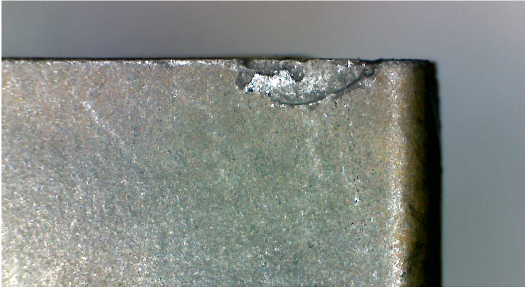
Figura 4.21- Pastilha CVD M15 com lascamento, após a usinagem com v_c = 130\text{m/min} e baixa pressão. Mic. óptico, 55x
