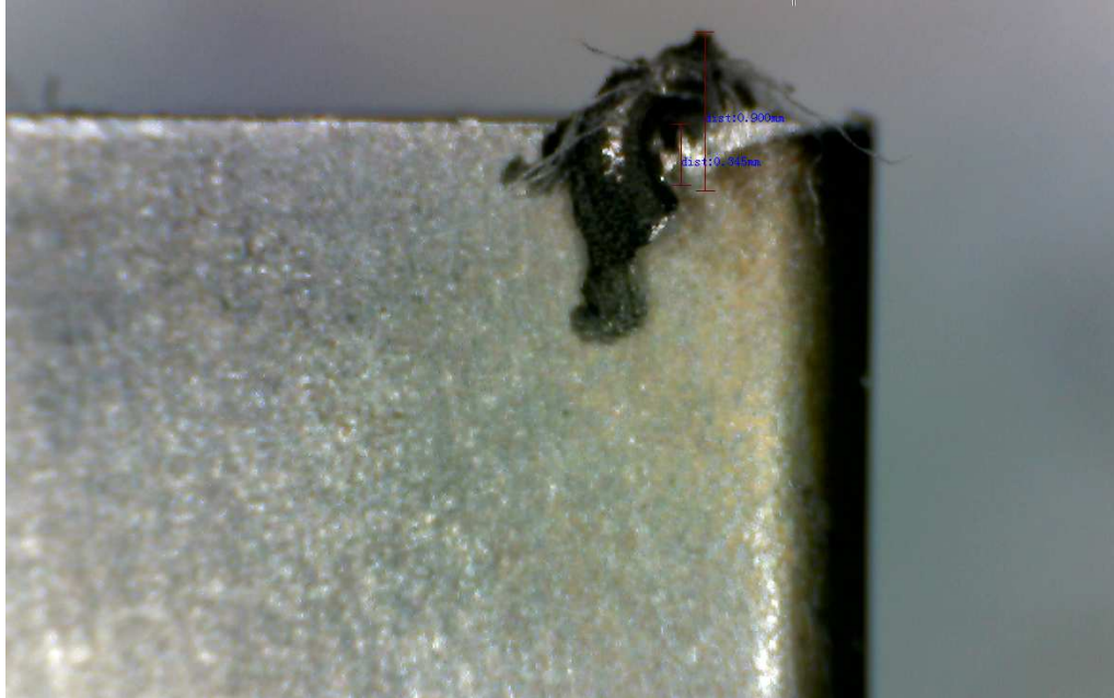
Figura 4.8- Aderência sobre aresta de corte em pastilha PVD M15 após a usinagem com v_c= 130 e baixa pressão. Mic. óptico, 55x
