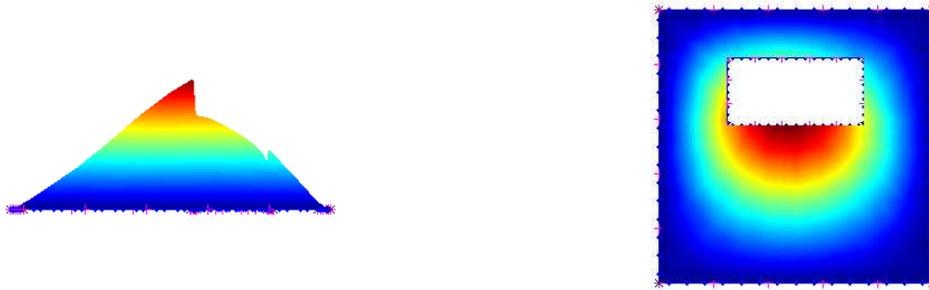
Figura 5.10: Vista de perfil do primeiro modo de flambagem com  $d/a = 0,50$  e  $e/a = 0,20$ . Figura 5.11: Vista de topo do primeiro modo de flambagem com  $d/a = 0,50$  e  $e/a = 0,20$ .
