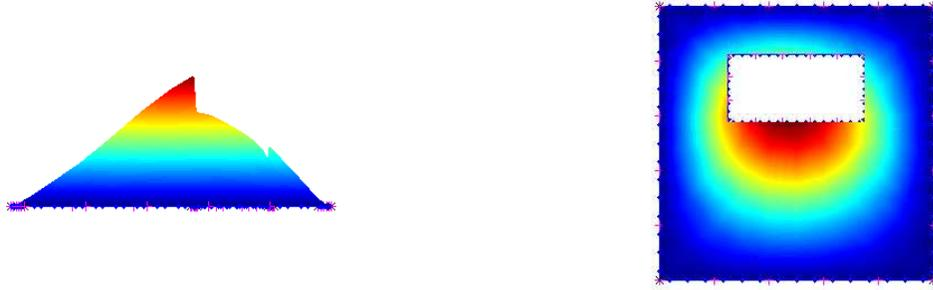
Figura 5.12: Vista de perfil do primeiro modo de flambagem com  $c/a = 0,50$  e  $f/a = 0,20$ .
