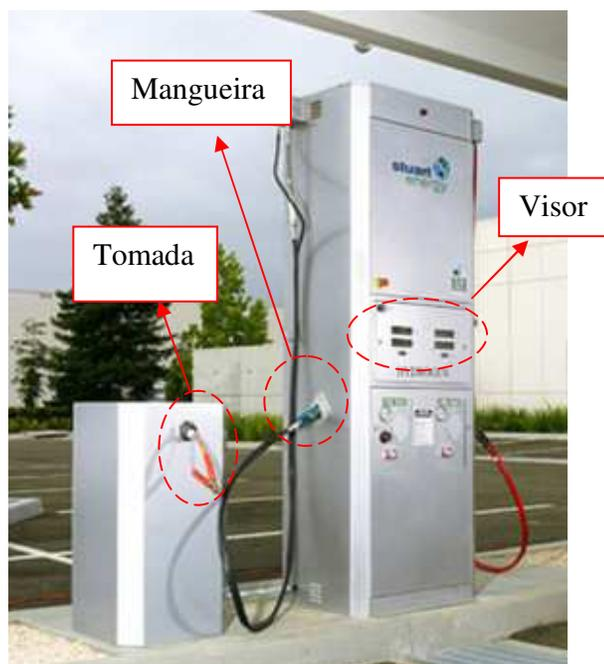
Figura 2.5 - Sistema de abastecimento de hidrogênio da Stuart Energy.
