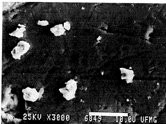
Fig. 4.8.1 - Resíduo da liga fundida centrifugado e submetido a vibração ultra-sônica - MEV.
