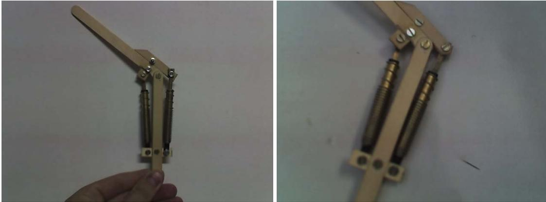
**Figura 62. Primeiro protótipo para junta do cotovelo**
