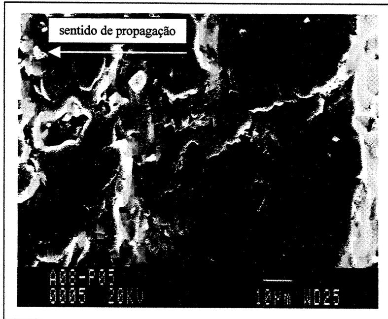
Figura 4.19 – Superfície de fratura da liga AA6261-T6, ensaiada com 0,4% de amplitude de deformação total. *Vida*: 4932 ciclos. Detalhe da região indicada pela seta E da figura 4.17. Aspecto microscópico da região de propagação da trinca principal. MEV.
