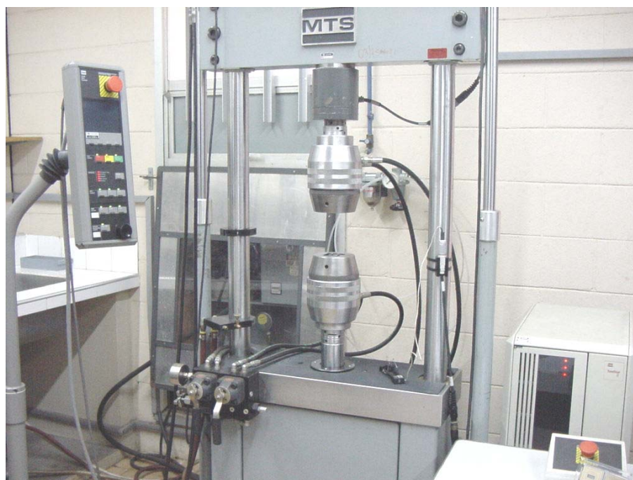
Figura 3.12 – Equipamento utilizado nos ensaios de tração das ligas de titânio.
