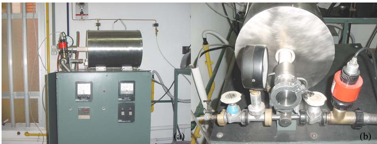
Figura 3.4 - Detalhes do forno utilizado para o tratamento térmico de homogeneização: (a) vista lateral, (b) vista frontal.
