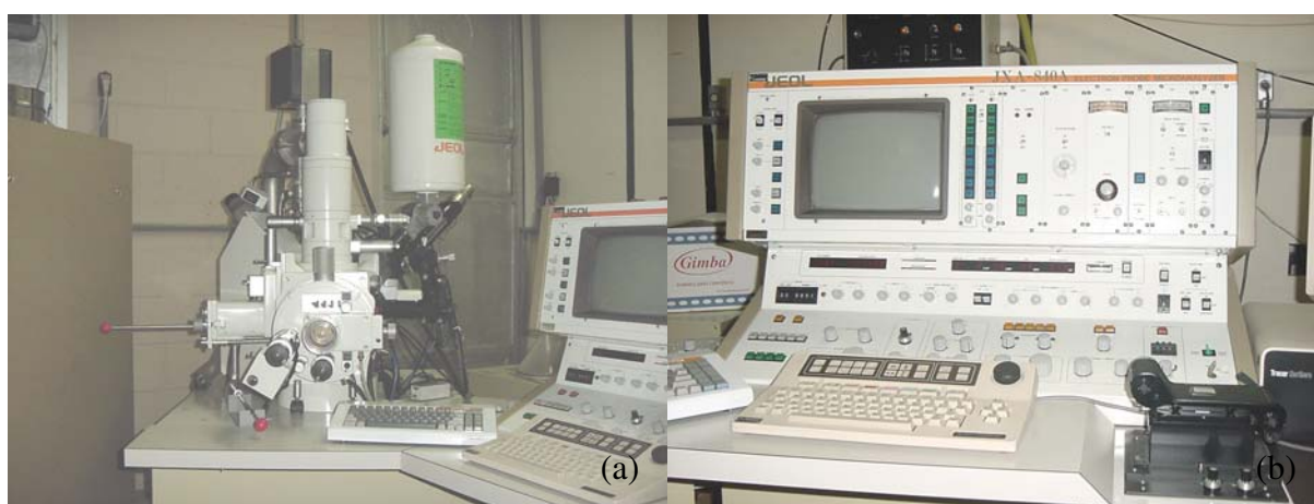
Figura 3.7 – Detalhes do microscópio eletrônico de varredura: (a) canhão de feixes de elétrons e (b) analisador de imagens
