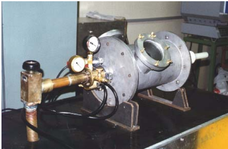
Figura 3.2 - Forno a arco em operação.
