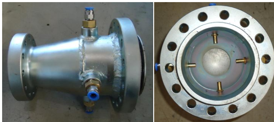
Figura 4-5. Carretel para injeção de ar na sucção da BCS.
